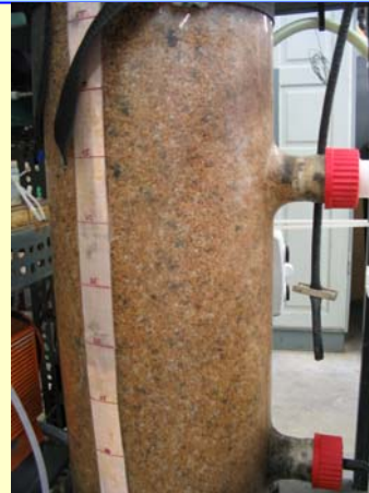
Abb. 3: Reaktor mit bewachsenem PCL-Granulat
