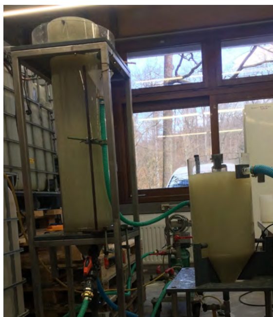
Abb.: Kontaktreaktor zur Ammoniumentfernung aus Abwässern.
