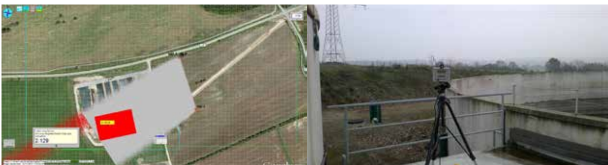
Gasfinder®-Messungen und Modellierung an einer Biogasanlage
