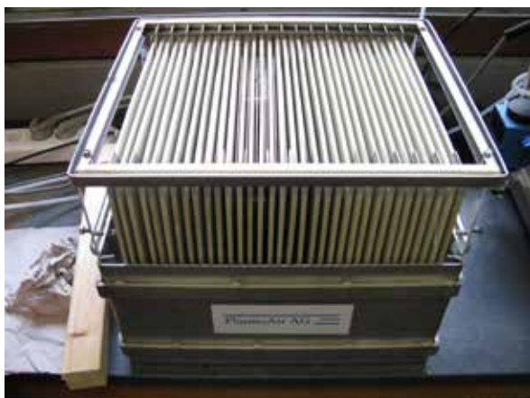
Dielektrische Barriere-Entladungs-Magazin (DBD-Stack) für die Erzeugung des Kaltplasmas zur Reinigung des Abluftstroms.
