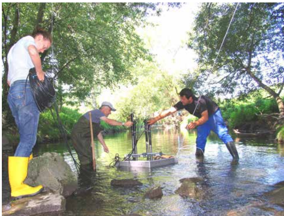
Abb.: Einbau der Online-Messungen in der Schwippe
