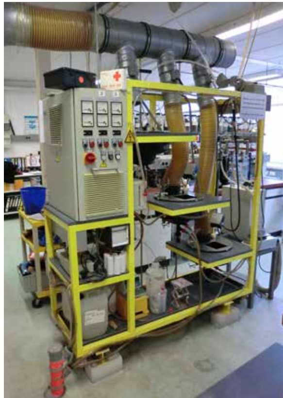
Abb.: Versuchsanlage mit UV-Freispiegelreaktor zur Phosphonat-Elimination
