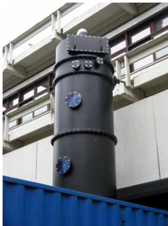
Biotricklingfilterkolonne der mobilen Versuchsanlage eingebaut im Container.
