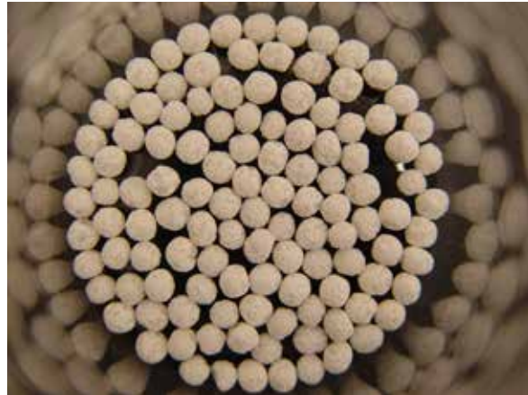
Abb.: MAP Pellets, hergestellt aus synthetischem Abwasser
