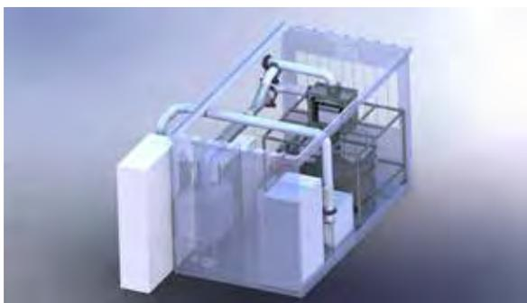
*Mobile Containeranlage mit nicht-thermischem Plasma und Mineraladsorber für den Einsatz an verschiedenen Standorten*
