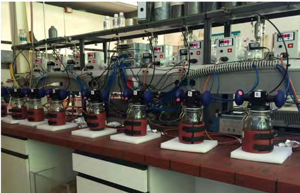
Laborsystem Yieldmaster zur Untersuchung der spezifischen Gasausbeute verschiedener Substrate
