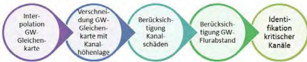
Abbildung 3: Prozessablauf GIS-Methodik zur Identifikation von Kanälen, die nach Kanalsanierung zu kritischen Grundwasseranstiegen führen können (Bachmann et al. 2015b)
