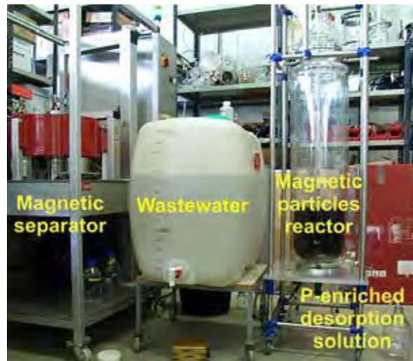
Abbildung: Versuchsaufbau zur Phosphorrückgewinnung aus Klärwerksablauf mit Hilfe magnetisch abtrennbarer, wiederverwendbarer Ionentauscher-Partikel.
