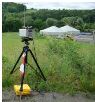
*Gasfinder®-Messungen und Modellierung an einer Biogasanlage*
