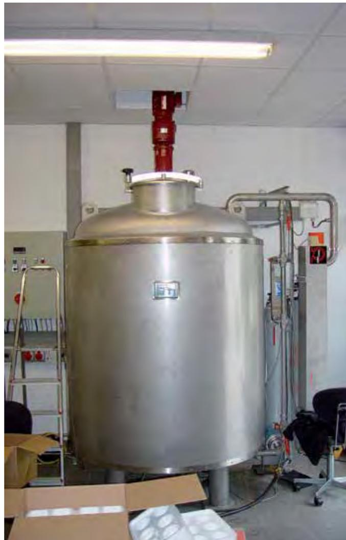
*Edelstahltank (2,1 m<sup>3</sup>) zur Pasteurisierung von Abwasser, Grund- und Trinkwasser*
