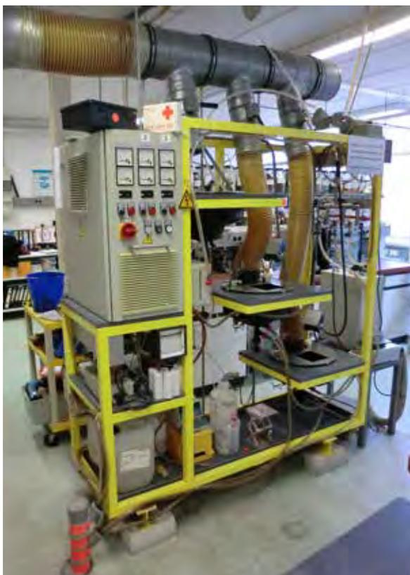
Abb.: Versuchsanlage mit UV-Freispiegelreaktor zur Phosphonat-Elimination
