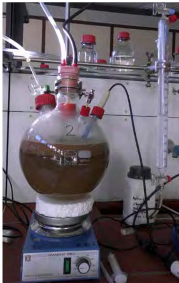
Abb.: Batchversuche im Labormaßstab
