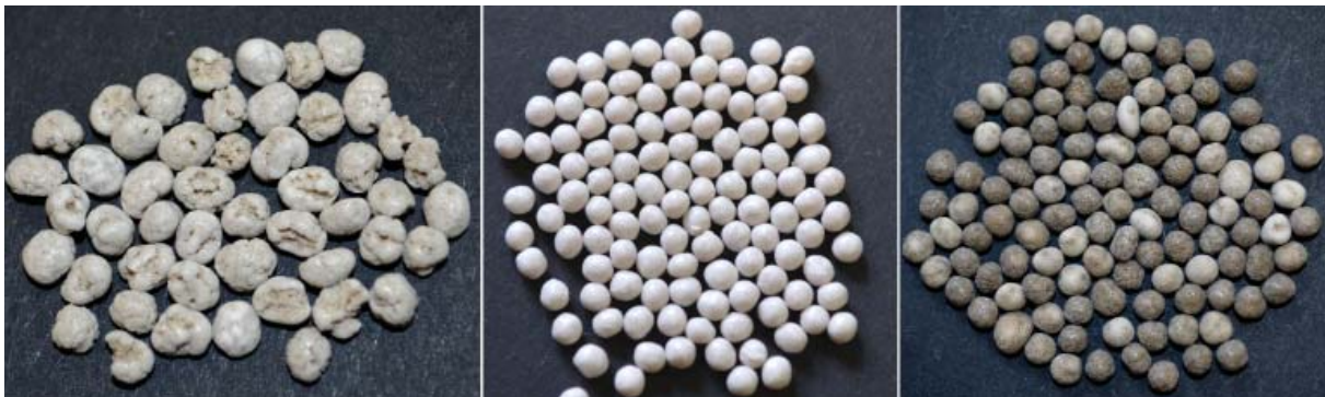
Abb.: MAP Pellets, hergestellt aus Abwasser des LFKW (links), Industrieabwasser (Mitte) und vorbehandeltem Faulschlammfiltrat (rechts)
