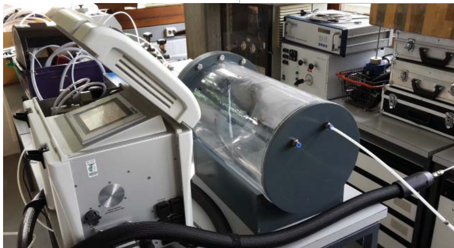
Abbildung: Messzylinder zur Vergleichsmessung mit trockenem und feuchtem Messgas
