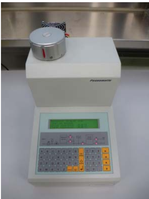
Bild: Thermogravimetrie und Heliumpyknometrie als geeignete Nachweisverfahren
