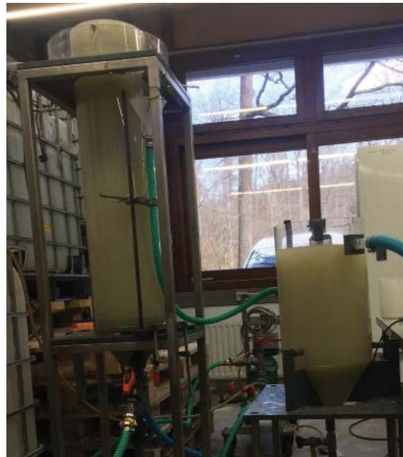
Abb.: Kontaktreaktor zur Ammoniumentfernung aus Abwässern.
